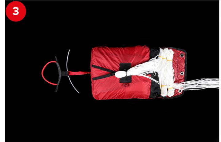
Falten Sie die Leinen zu symmetrischen Schlaufen in der ungefähren Breite des Innencontainers. Verwenden Sie Gummibänder, um die Schlaufen zu sichern, und stapeln Sie die Bündel ordentlich am Boden des Containers.
