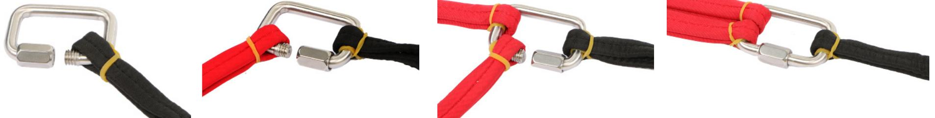
**! WARNUNG:** Bei der Verbindung der Rettungsgeräteverbindungsleine mit dem Gurtzeug muss man die Verbindung mit Klebeband, Gummiringen oder einem weichen Schrumpfschlauch sichern. Nicht gesicherte Verbindungen könnten zu hohe Reibung und Reibungswärme zur Folge haben.
